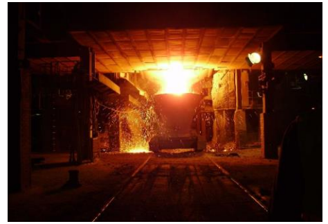
Obrázek č. 6: Lití surového železa z vysoké pece s názvem „Veronika“
