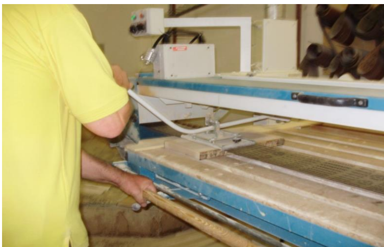
Obrázek 1: Umístění měřicí aparatury na separaci frakcí na pásové brusce
