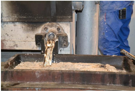
Obrázek č. 8: Odpich roztaveného surového olova ze sifonu do formy
