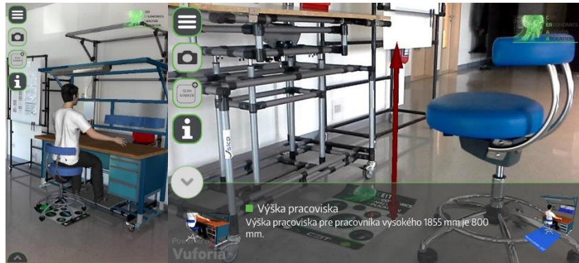
Obrázek 1: Návrh vhodných ergonomických parametrov pracoviska a vykreslenie výšky pracovného stola pre výber muž – P95 percentil – sed, formou rozšírenej reality (Gašová, M.)
