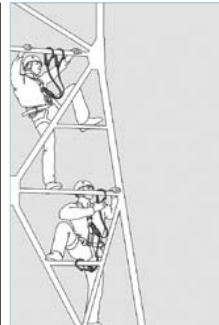
Obr. 18: Příklad přístupu po konstrukci
